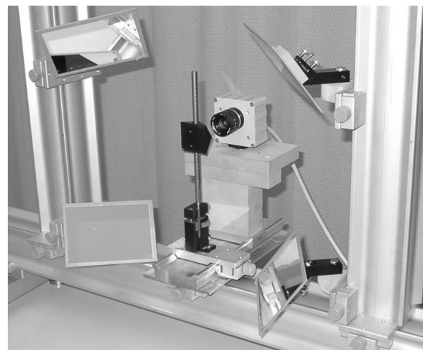
Abbildung 2-5: Vierfach-Strahlteiler mit einer digitalen Highspeed-Kamera vom Typ Fastcam Ultima 1024 (PUTZE & HOYER 2005)
