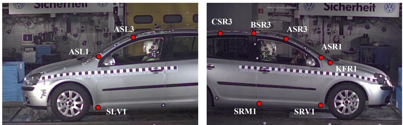
Abbildung 6-11: Darstellung der zehn Zielmarken am Fahrzeug (rote Markierungen), die für die Bestimmung der Transformationsparameter genutzt werden, links: Ansicht der linken Fahrzeugseite, rechts: Ansicht der rechten Fahrzeugseite
