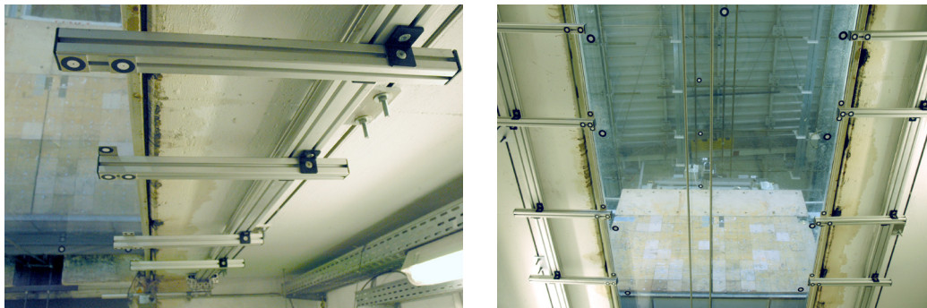
Bild 4-4 Passpunktadapter Darstellung der konstruierten Passpunktadapter in der Fotogrube, angebracht an stabilen Schienenführungen ca. 30 cm unterhalb der Passpunkte auf der Acrylglasabdeckung.
