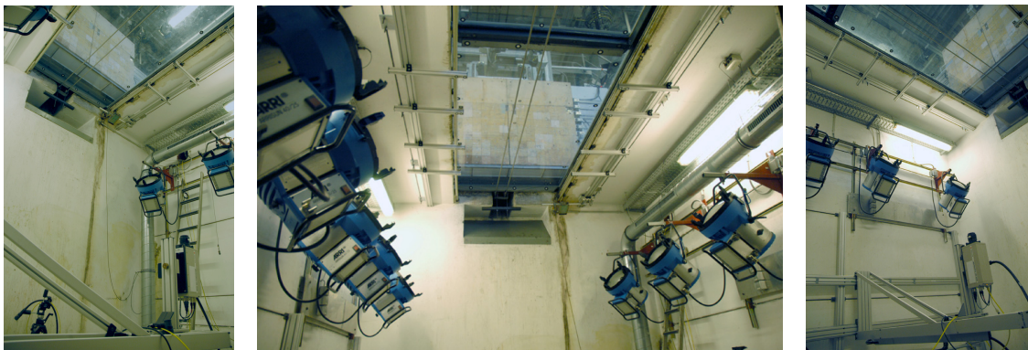
Bild 4-11 Aufnahmesituation in der Fotogrube Darstellung der Fotogrube inklusive Scheinwerfern, Passpunktadaptern und Blick auf die Acrylglasplatte (Mitte). Links und rechts ist zusätzlich die Kameraposition U1 dargestellt.
